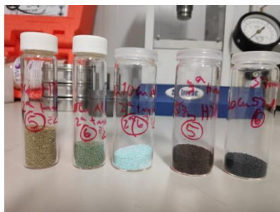
Figura 2: Catalizadores de base hidrotalcita y alúmina preparados recientemente en el CIEMAT
