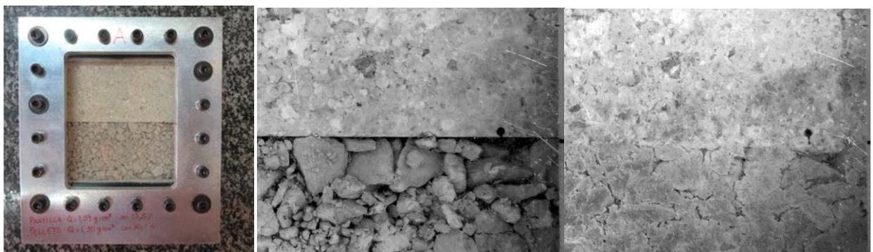
Figura 1: Celda Transparente (izquierda), e imágenes de su interior (Foto central: contacto entre pellets y bloque antes de comenzar la hidratación. Foto derecha: contacto después de dos meses de ensayo).
