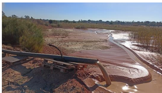
Fig 1. Evacuación de lodos residuales de una planta de lavado de áridos
